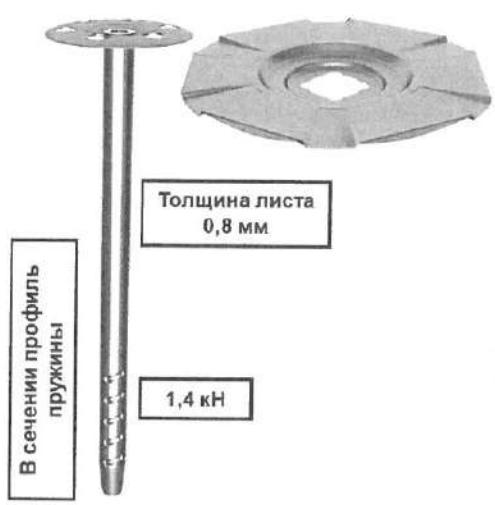
При монтаже длина крепежного элемента выбирается исходя из толщины огнезащитной плиты ISOTEC. Для обеспечения постоянства вырывного усилия все анкера (независимо от длины) имеют одинаковую распорную зону – длиной до 50 мм.
