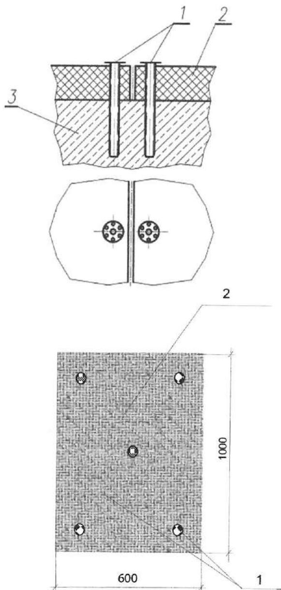
Рис. 2. Схема крепления минераловатных плит ISOTEC (размер плиты 1000×600). 1 – анкер; 2 – плита минераловатная ISOTEC; 3 – поверхность железобетонной плиты.
