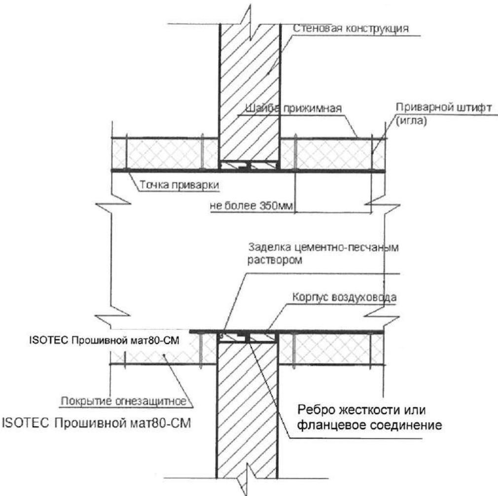
**Рис. 9. Принципиальная схема пересечения воздуховодом строительной конструкции**
