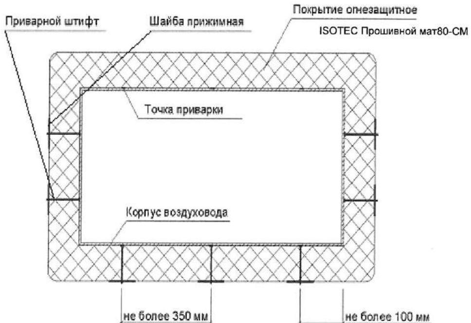
Рис.4. Принципиальная схема расположения матов по периметру воздуховода
