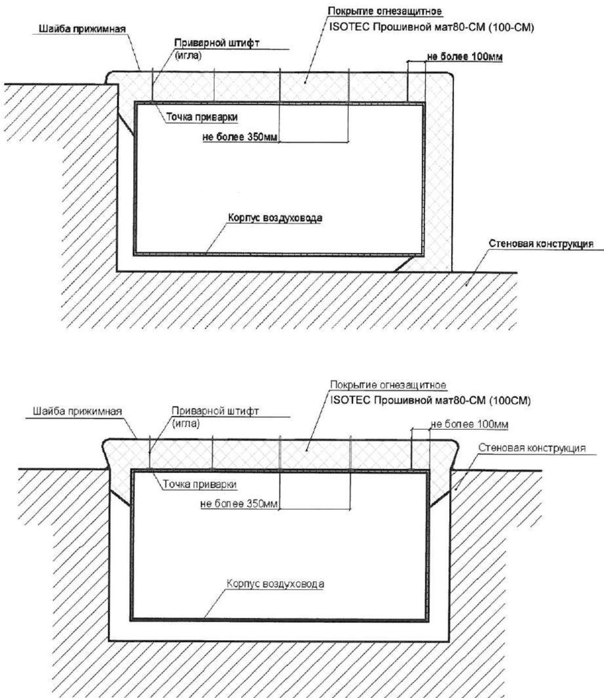
**Рис. 7. Огнезащита воздуховода, расположенного вблизи стеновых конструкций**
