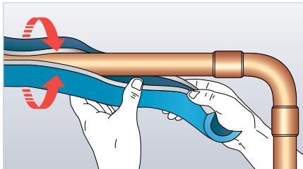
Раздвиньте самоклеящиеся кромки трубы Armaflex и наденьте на трубу (защитная пленка все еще защищает самоклеящуюся полоску).
