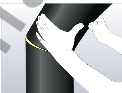
Нанесите клей Armaflex на продольный шов, затем на поперечные швы между частями.
