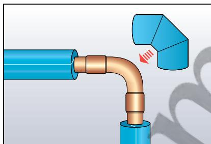
Заизолируйте участок трубы, как описано в разделе «Изоляция колена с одним промежуточным сегментом 2+1»).
