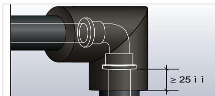
Заизолируйте трубу до фитинга трубкой Armaflex и закрепите изоляцию на трубе с помощью клея.
