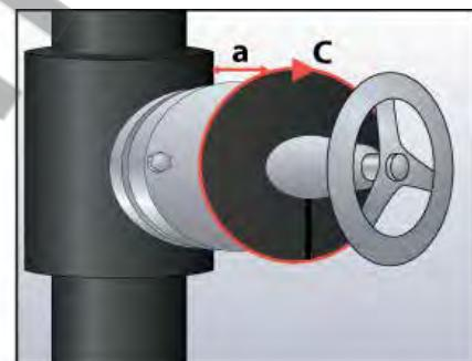
Разрежьте полученный диск с одной стороны, нанесите клей на торцы разреза, дайте подсохнуть. После установки диска на фланце выступающей части соедините вместе его концы. Измерьте длину окружности с полученного диска с помощью полосы из материала Armaflex и перенесите измерения на листовой материал. Измерьте наименьшую (a) и наибольшую (b) длину выступающей части вентиля. К наибольшей длине (b) прибавьте толщину материала.
