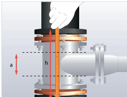
Сделайте заготовки для изоляции корпуса клапана.
