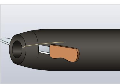
Подрежьте заготовку до нужной длины, добавьте по 5 мм с каждой стороны для того, чтобы швы были сжаты. Разрежьте полученную заготовку.
