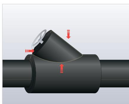
Вырежьте заготовку из листа. Снимите фаски с кромок листа, где он соприкасается с изоляцией. Нанесите клей на продольный шов и дайте засохнуть. Натяните изоляцию на вентиль.
