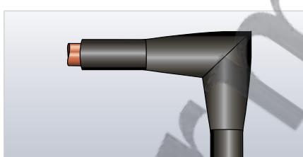
1. Изоляция фитинга делается из трубы, внутренний диаметр которой соответствует максимальному внешнему диаметру изолируемого фитинга. С каждого конца трубка должна перекрывать фитинг не менее чем на 40 мм от края фитинга.
