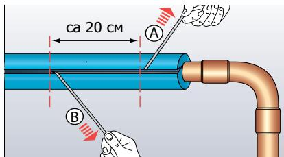
Снимите защитную полоску с обеих сторон разреза путем стягивания ее с изоляции.
