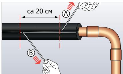
Снимите защитную полоску с обеих сторон разреза путем стягивания ее с изоляции.
