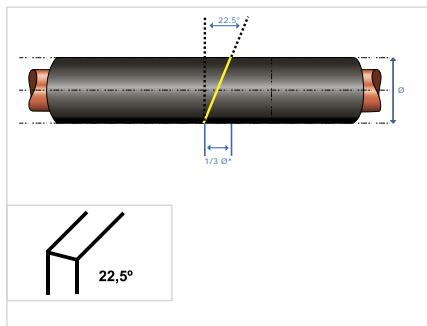
\* Соотношение диаметров, указанные на схеме для достижения угла 45°, являются приблизительными.
