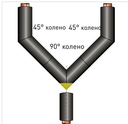
**Примечание:** Желтые линии показывают, где необходимо сделать разрезы. Для правильного измерения угла используйте шаблон Armaflex, размещенный на каждой коробке с трубной изоляцией Armaflex.
