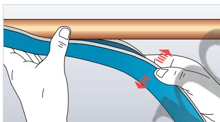
Отрегулируйте расположение трубы Armaflex таким образом, чтобы убедиться, что место разреза трубы легко доступно.
