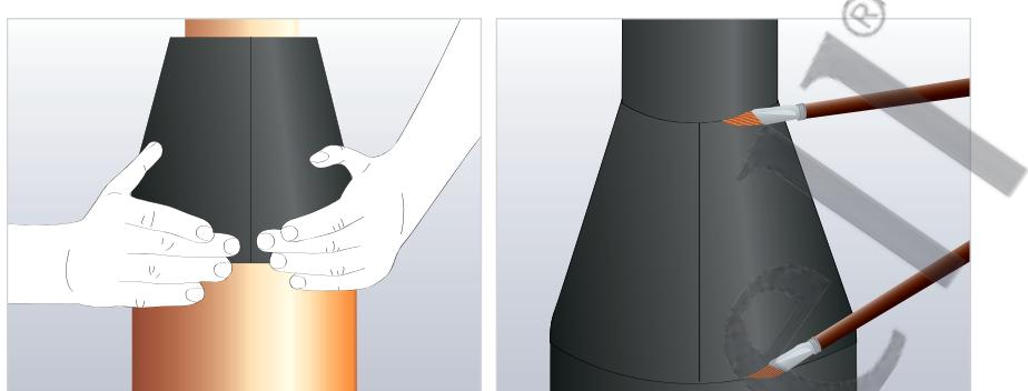
Нанесите тонкий слой клея на склеиваемые кромки, дайте подсохнуть. Сожмите края сначала с одной стороны, затем с другой, завершите склеивание швов.
