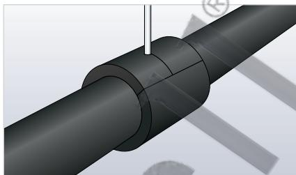
3. Расположите подготовленный отрезок трубы Armaflex вокруг хомута, отметьте и подрежьте его до необходимой длины. Установите заготовку на трубу. Тщательно проклейте все швы со всех сторон и убедитесь, что полученная система полностью герметична.
