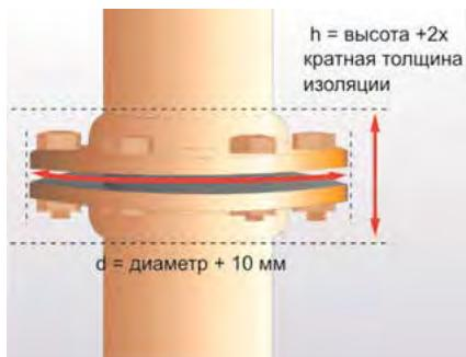
С помощью кронциркуля определите диаметр фланца. Добавьте 10 мм к этому размеру. Измерьте высоту фланца (включая болты) и добавьте 2-кратную толщину листа, который используется для изоляции.
