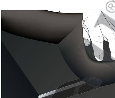
7. Разместив рамку Armaflex по периметру выступающего шва воздуховода, нанесите клей на оставшийся незаклеенный угол и склейте его для завершения конструкции.
