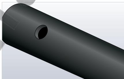
Для вырезания небольших отверстий удобно использовать пробойники (заточенные отрезки труб).
