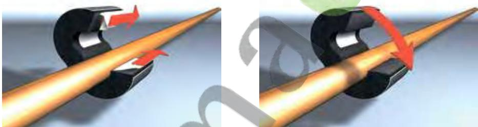
Подвесы Armafix изготовлены из изоляции Armaflex со специальными вставками из стойкого к нагрузкам жесткого PET полиэтилентерефталата, закрытыми снаружи прочными алюминиевыми пластинами полукруглой формы.
