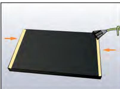
Нанесите клей Armaflex на кромки, как показано на рисунке.
