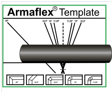
При изготовлении колен и тройников из трубок Armaflex необходимо, чтобы теплоизоляционные трубы были разрезаны под различными углами. Для того чтобы ускорить и облегчить этот процесс, на каждой коробке с трубной изоляцией Armaflex напечатан специальный шаблон, который можно вырезать и использовать в работе.
