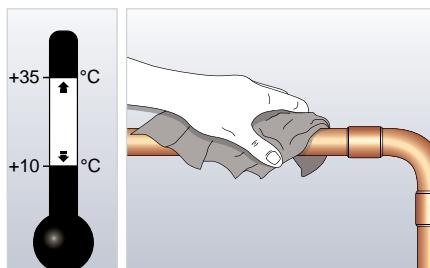
Очистите трубопровод от пыли, грязи, масла и воды, при необходимости применяя очиститель Armaflex.
