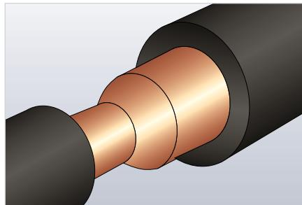
Необходимо изолировать сужение трубы либо место соединения двух труб разного диаметра.
