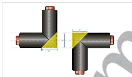
**Примечание:** Желтые линии показывают, где необходимо сделать разрезы. Для правильного измерения угла используйте шаблон Armaflex, размещенный на каждой коробке с трубной изоляцией Armaflex.
