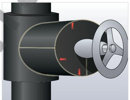
**Важно:** герметичное соединение в области выхода шпинделя из изоляции особенно важно.
