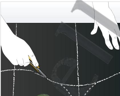
Начертите арку от центральной линии к противоположным углам радиусом, равным длине окружности трубы. Окружности могут касаться друг друга только в одной точке.
