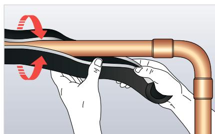
Раздвиньте кромки самоклеящейся трубы Armaflex и наденьте на трубу (защитная пленка все еще защищает самоклеящуюся полоску).
