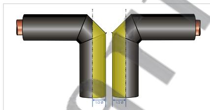
**Примечание:** Желтые линии показывают, где необходимо сделать разрезы. Для правильного измерения угла используйте шаблон Armaflex, размещенный на каждой коробке с трубной изоляцией Armaflex.
