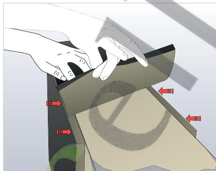
После того как клей немного подсох [«пальцевый метод»], установите на проклеенную поверхность изоляцию Armaflex и аккуратно прижмите для хорошего сцепления. Продолжайте работу, нанося клей Armaflex на обе поверхности, включая кромки листового материала и устанавливая изоляцию на воздуховод после того, как клей немного подсохнет.
