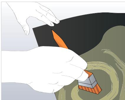
Нанесите тонкий слой клея на металлическую поверхность воздуховода, а затем на лист Armaflex.
