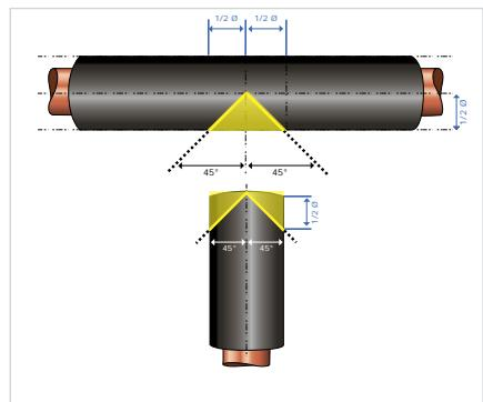
1. Вырежьте с помощью шаблона Armaflex 2 угла по  $45^\circ$  на конце примыкающей трубы, как показано на рисунке.
