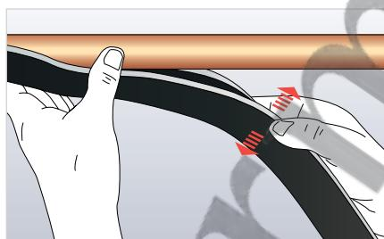
Отрегулируйте расположение трубы Armaflex таким образом, чтобы убедиться, что место разреза трубы легкодоступно.
