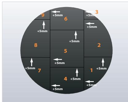
Для определения точной формы отреза листа Armaflex для верхней части резервуара пометьте край уже установленной на вертикальную поверхность изоляции мелом. Поместите лист Armaflex с перехлестом в 50 мм сверху края резервуара и сильно прижмите. На обратной стороне листа Armaflex отпечатается необходимая линия отреза.
