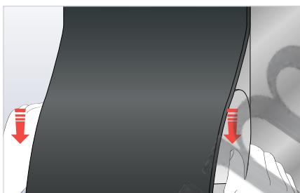
Выровняйте материал и продолжайте устанавливать изоляцию, прижимая ее и медленно снимая защитную пленку. На стыковых соединениях оставьте нахлест 5 мм для сжатия материала.
