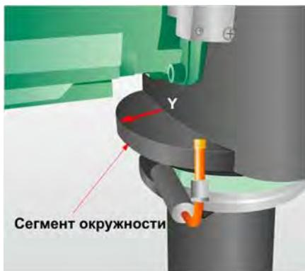
8. Сделайте отверстия фланца: определите диаметр фланца  $d_1$ , окружность  $U_2$ , высоту  $H_2$  и вырезы для соединения изолированного трубопровода.
